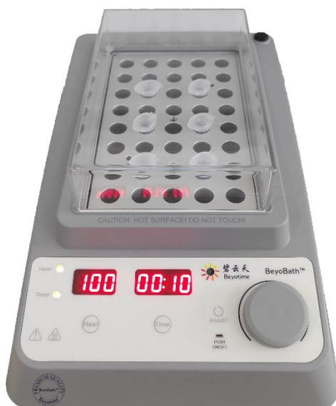
图2. BeyoBath™干式恒温金属浴(E6662)运行示意图。
